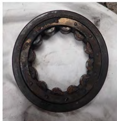
Foto nr.5: Rulment cu role gripat și supraîncălzit.
