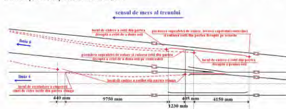
Figura nr.3 - Schița cu urmele de deraiere constatate pe schimbătorul de cale nr.26
