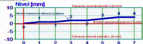
Figura nr. 6 - Diagrama nivelului transversal măsurat
