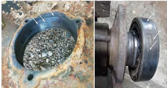
Foto nr.2: Urme de frecare pe rulment și pe scut.
