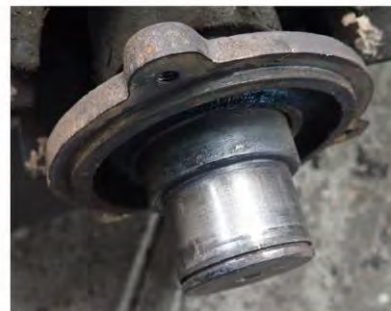
Foto nr.4: Axul motorului cu urme de frecare ale inelului interior al rulmentului.
