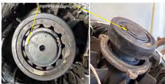
Foto nr.6: Siguranța zegger ruptă..
