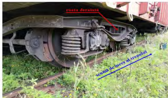
Foto nr. 1 - Detaliu vagonului nr. 31535375239-9 deraiat de către prima osie de la al doilea boghiu în sensul de mers
