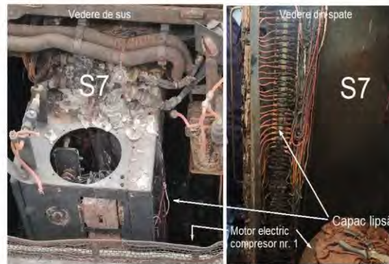
Foto nr.1: Lipsă capac de protecție cablaj și placă de borne S7.
